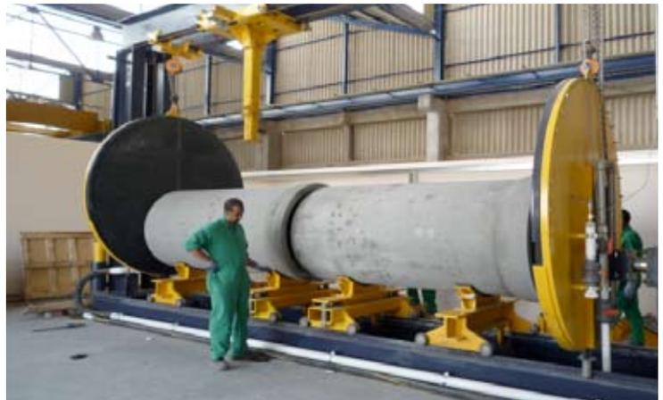
HYDROSTATIC PRESSURE TEST FOR JOINTS
